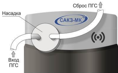
Рисунок Е.1 – Схема установки насадки
